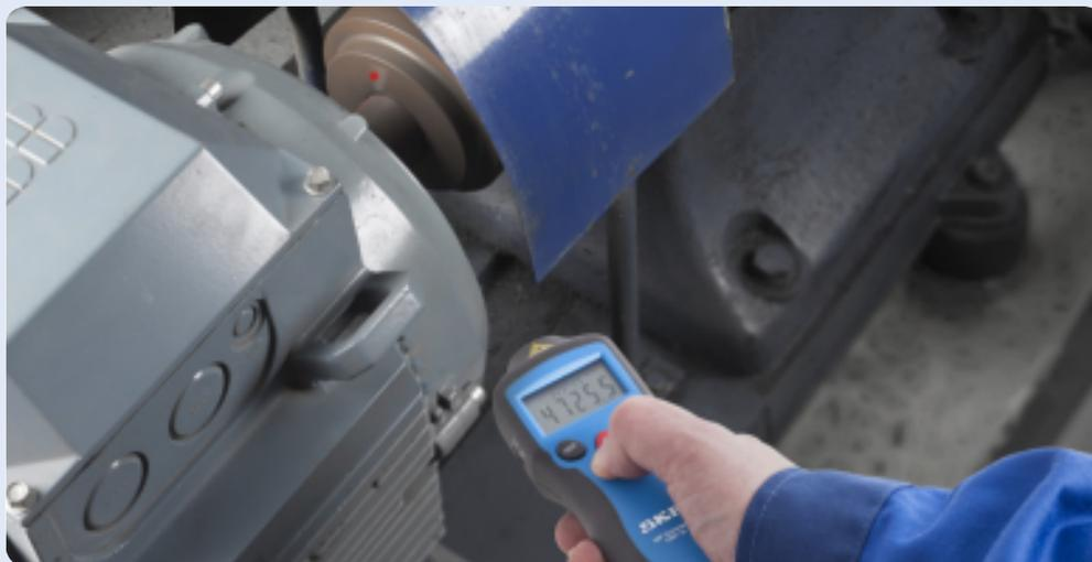
凭借激光光学系统，使用者可在旋转机械的安全距离处轻松、快速地进行测速。
